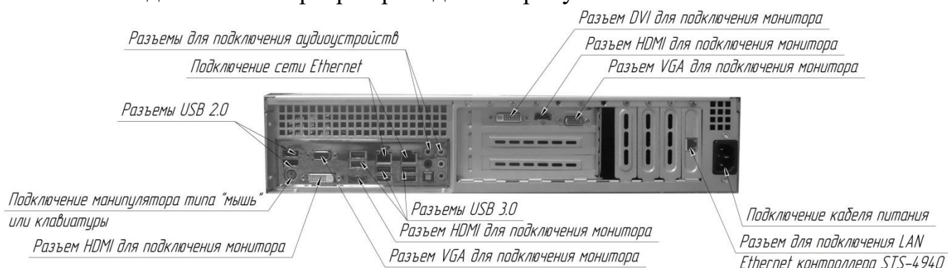
Рисунок 1 – Подключение сервера (расположение, внешний вид, типы разъемов и их количество может отличаться от приведенного)
